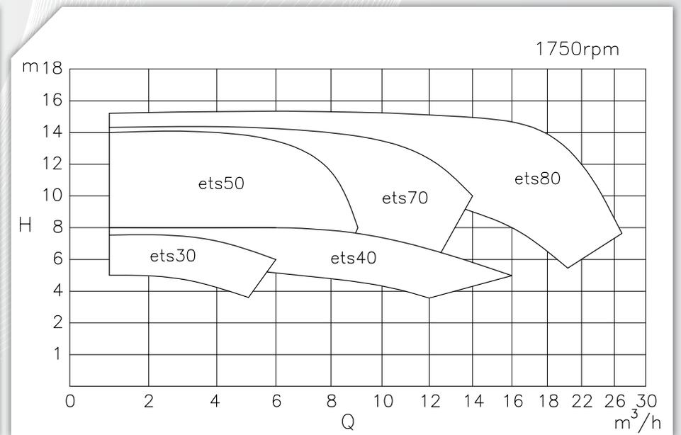
Unverbindliche Daten beziehen sich auf Wasser bei Raumtemperatur. Zu speziellen Leistungskurven kontaktieren Sie bitte CDR Pompe S.r.l.
